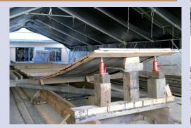
Cm par cm une partie des planches (à l'avant de la sole) va subir une pression jusqu'à la courbure souhaitée. Cette séquence dure quelques semaines.
